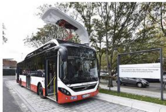
FIGURA 3. PANTÓGRAFO UTILIZADO EN CIUDAD DE MORITZ, SUIZA. FUENTE: PLATAFORMA DE LA ELECTROMOVILIDAD, MINISTERIO DE ENERGÍA DE SANTIAGO DE CHILE.
