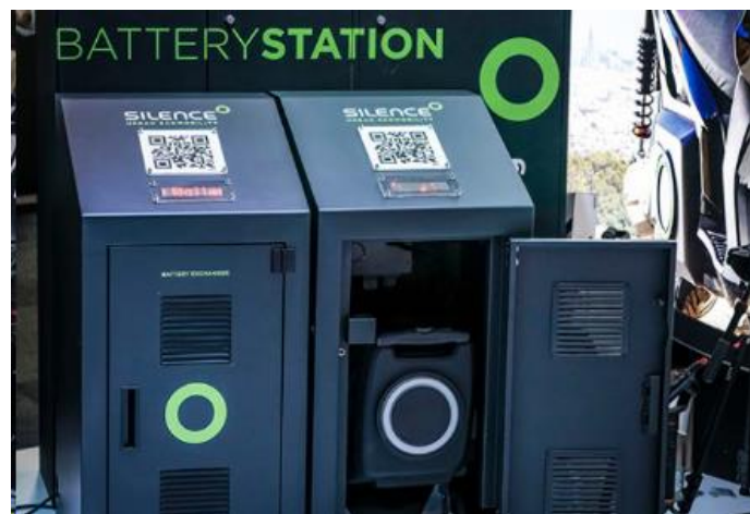
FIGURA 2 ESTACIÓN DE INTERCAMBIO PARA BATERÍAS DE SILENCE (BATTERY SWAP). FUENTE: MOVILIDAD ELECTRICA.COM
